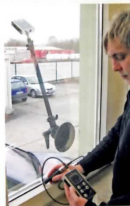
Im drucklosen Bereich wird der Sender von außen mit dem Profisaugnapf an der Glasscheibe befestigt während der Empfänger im Innenraum abgelesen wird.
